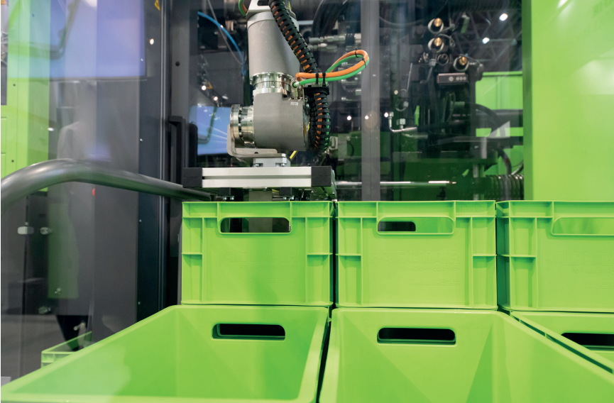
Bild 3. Das Skinmelt-Verfahren versteckt das Rezyklat unter einer Oberfläche aus Neuware – z.B. bei Transportboxen © Engel
